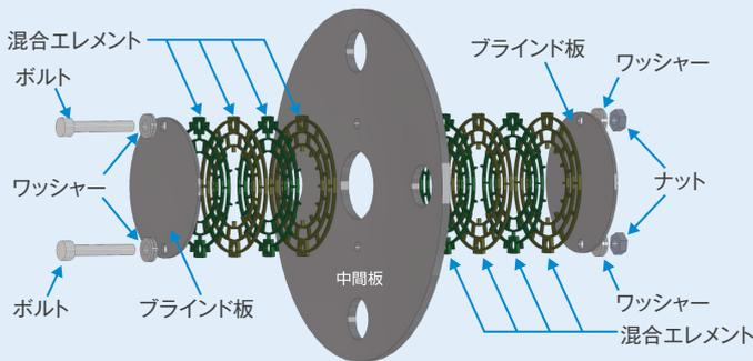
フランジ間に挿入するだけで液体を混合することができます。
