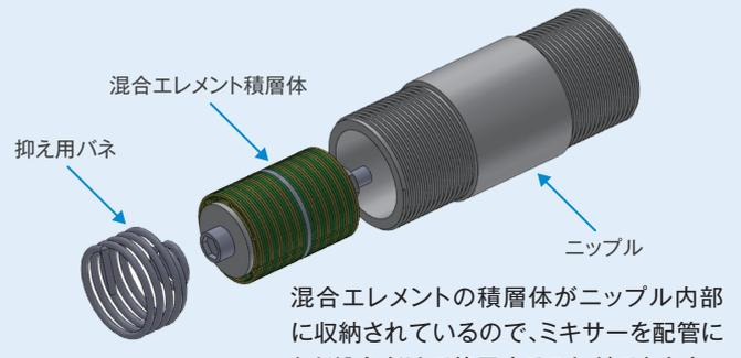
混合エレメントの積層体がニップル内部に収納されているので、ミキサーを配管にねじ込むだけで使用することができます。
